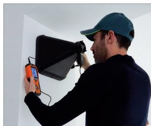
*Bien plaquer le joint du cône afin de garantir une mesure précise*
