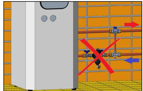
C'est strictement interdit d'installer le filtre séparateur magnétique avec son axe principal en horizontale ou avec l'appareil à l'envers.
