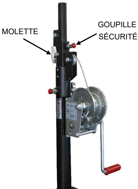
Pour éviter que la goupille ne se bloque à nouveau, maintenez-la en position rétractée tout en relevant légèrement le mât télescopique à l'aide de la manivelle. Une fois le tronçon ajusté, relâchez la goupille.
