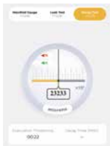
Niveau de vide dans la plage de mesure et supérieur à la valeur de maintien
